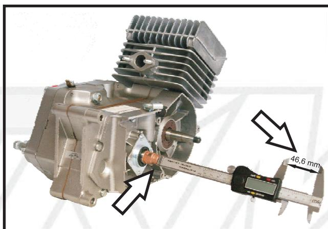
Der Montagedorf ist als erstes in die Abtriebswelle einzuführen. Danach kann die obere Schlitzmutter am Motorgehäuse nach links gedreht werden, bis sich unter leichten Gegendruck eine seitliche Verschiebung von dem Montagedorf in der Abtriebswelle bemerkbar macht.
